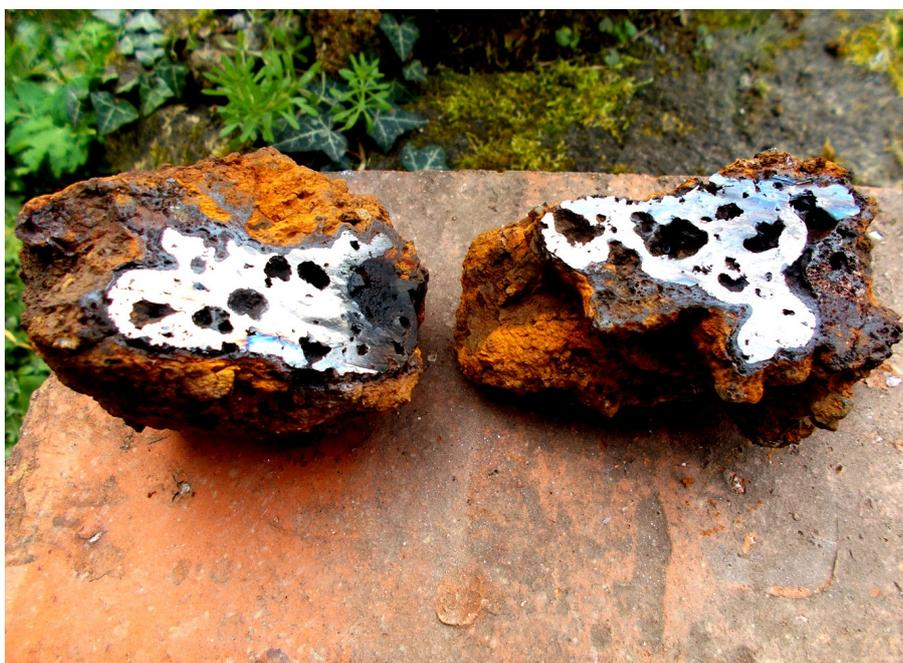
D'un poids de 1682 gr, il a été tronçonné et analysé pour en connaître la teneur en fer mais aussi les divers éléments le composant, ce qui, après analyse de minerais locaux pourrait nous renseigner sur l'origine de la mine utilisée.
